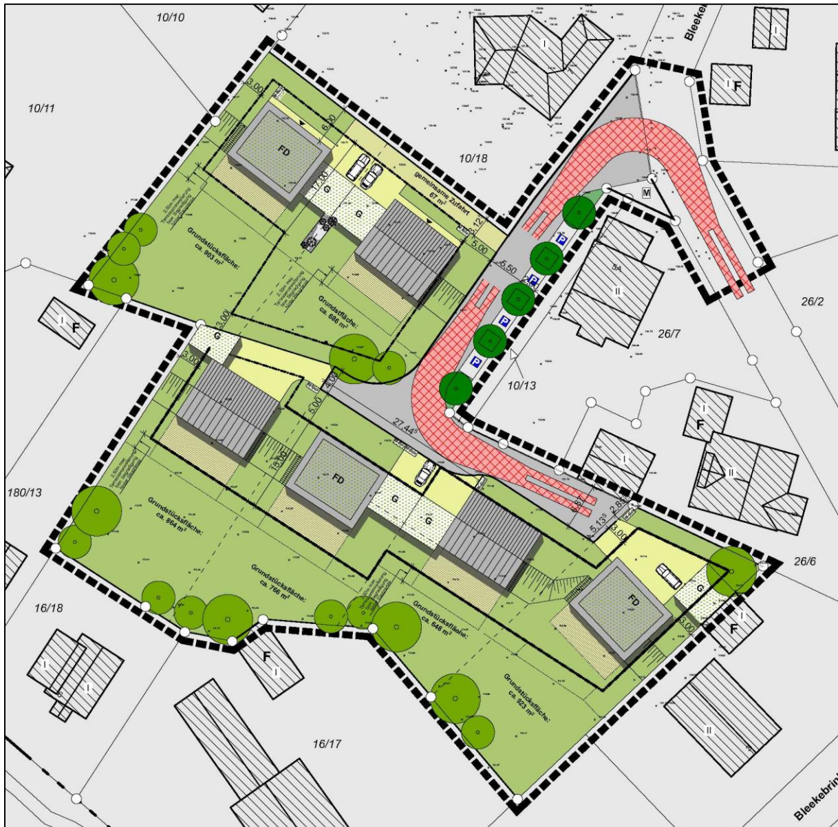
Abb.: Darstellung der Schleppkurven (A.S.A. Bauplanungs GbR, 29.02.2018)
